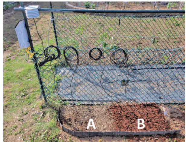
図3 マルチングによる地温と土壌水分の比較実験 A：無処理区。B：ガーデンモス処理区。
