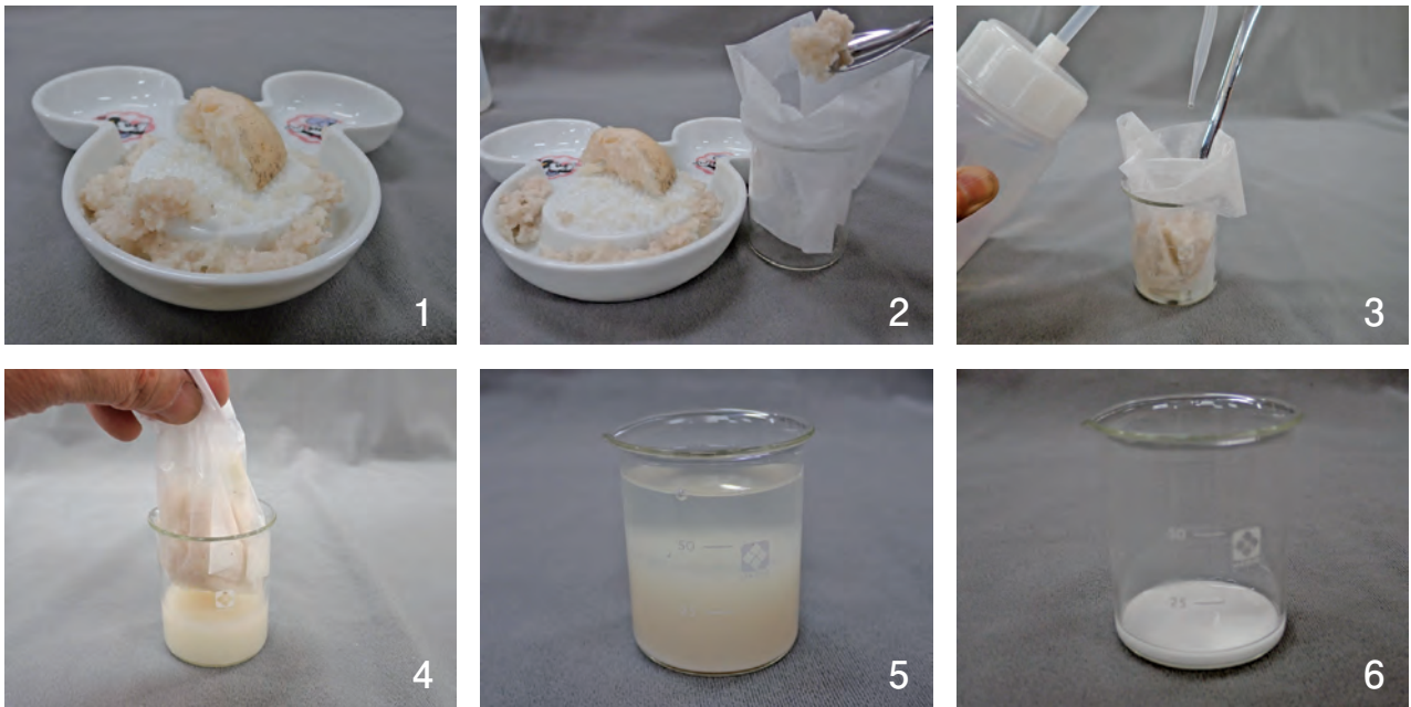
図1 でんぷん粒の採取（レンコン） 1：レンコンをすりおろす。2：コップにセットしたダシバックに詰める。3：水を加えて、絞り出す。4：バックを取り出し、水を加える。5：沈殿したら、新しい水と交換。6：水がきれいになったら、沈殿を集めて乾燥。
